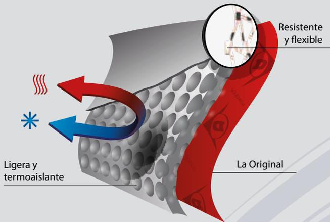
Purofort® es el material exclusivo de Dunlop® con millones de burbujas de aire distribuidas uniformemente para conseguir un producto ligero y termoaislante además de una estructura reticular que proporciona flexibilidad y resistencia.
